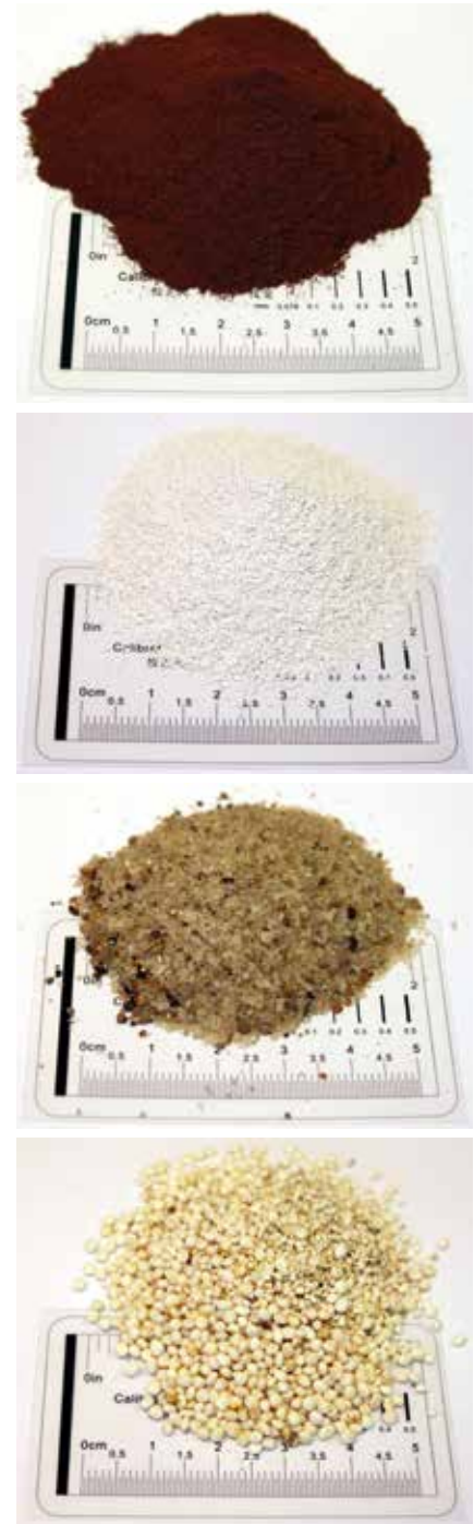
Abb. 1: Monoverbrannte Klärschlammasche (oben) und Produkte der Phosphorrückgewinnung aus Schlammwasser © Institut für Wassergüte, Ressourcenmanagement und Abfallwirtschaft
